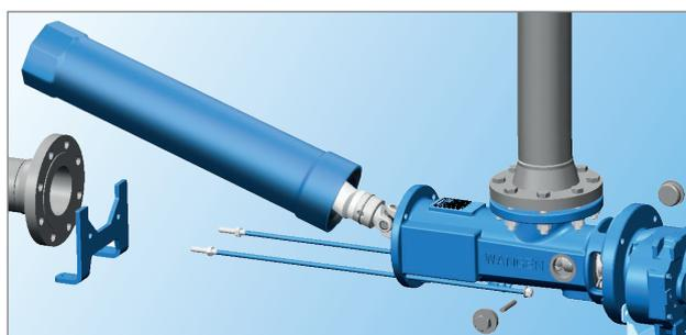
Passo 3: Tirare in avanti statore e rotore insieme all'albero cardanico, estraendoli dall'involucro di aspirazione e alzare
