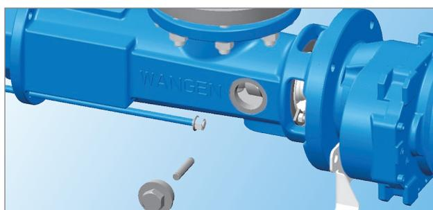
Passo 2: Svitare il tappo di chiusura e rimuovere il perno di collegamento
