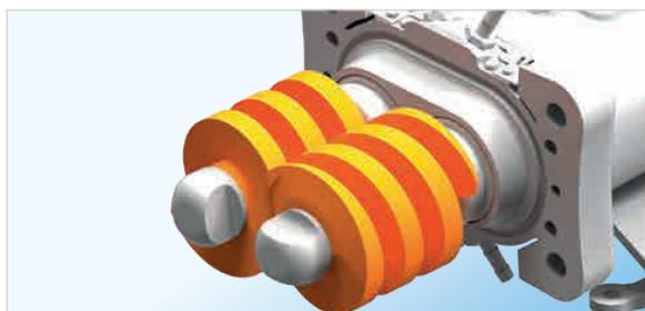
Efficiente e compatta, questa pompa è priva di contatti tra le parti rotanti. La pompa a doppia vite è stata sviluppata per trasferire in modo efficiente prodotti a bassa e alta viscosità, ma anche volatili o gassosi. Il suo design impedisce al prodotto di depositarsi in punti morti, evitando ristagni o fermentazioni. Grazie all'enorme flessibilità, può essere utilizzata sia per il trasferimento del prodotto che come pompa per eseguire il CIP (Cleaning In Place).
