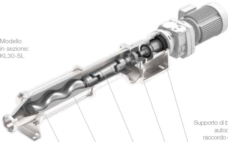
Supporto di banco con cuscinetti autocentrante e flangia di raccordo diretto con il motore. Questo per evitare danni al riduttore a ingranaggi.
