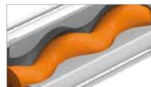
Statore a imbuto per facilitare il passaggio del prodotto. Statori in diverse geometrie di nostra produzione
