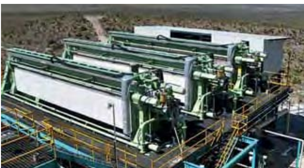
Filtro pressa - Cortesia di DIEMME
