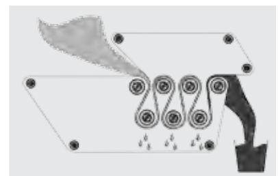
Schema funzionamento nastropressa
