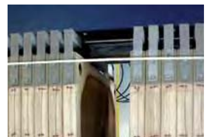
Particolare filtro pressa
